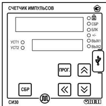
Рисунок 6.2 – Лицевая панель прибора для корпусов настенного И и щитового Ц1 крепления
