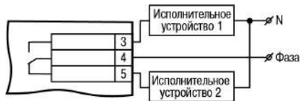
Рисунок 5.7 – Схема подключения нагрузки к ВУ типа Р
