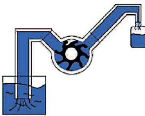
Без давления, пульсаций (поток идеально подходит для наполнения, дозирования или фильтрования)
