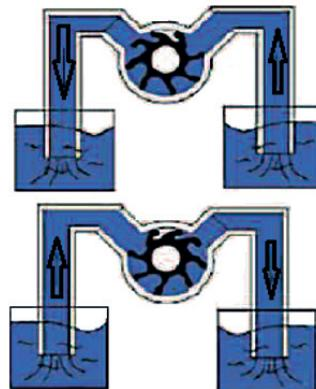
Может работать в 2-х направлениях. Это позволяет вернуть лишнюю жидкость без ручного вмешательства. Также, легкое опорожнение труб осуществляется при завершении перекачки жидкости.
