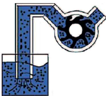
Перекачка чувствительных и густых жидкостей до 75.000 сПз, даже при наличии твердых взвешенных частиц без нанесения повреждений. Идеально подходят для перекачки кремообразных жидкостей и масс.
