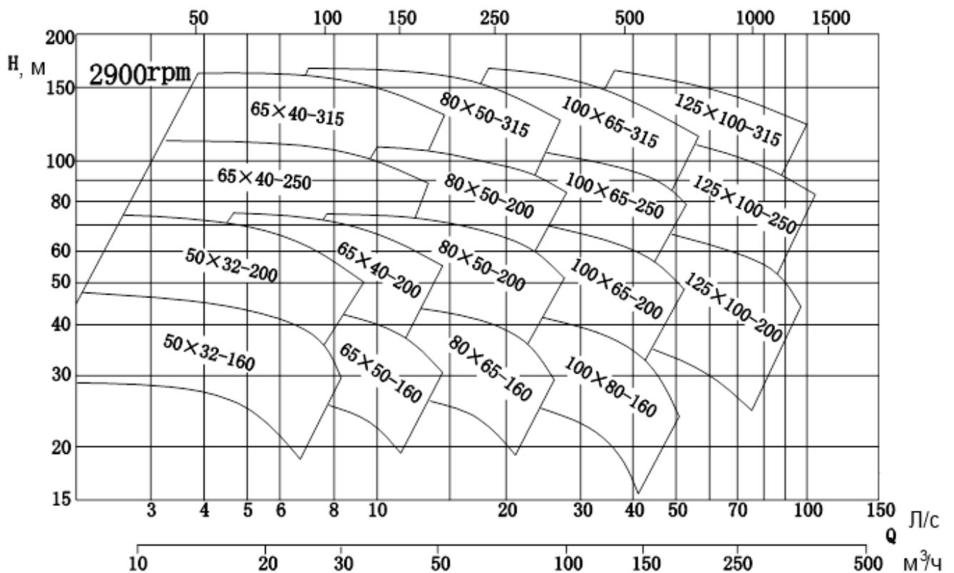
**6. Технические характеристики агрегатов электронасосных горизонтальных консольных центробежных одноступенчатых серий SMA(A). Таблица 6.**
