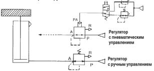
Давление регулируется в соответствии с изменением нагрузки. Обеспечивается балансировка как в статических, так и в динамических условиях.
