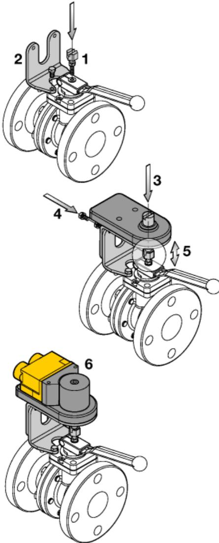
Завинтите самоподтягивающуюся гайку на винт привода и затем винт поводка в ручной клапан.
