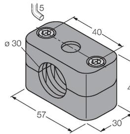
Монтажный зажим для цилиндрических гладких и резьбовых датчиков; материал: Полипропилен
