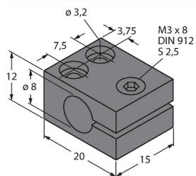
Монтажный зажим для цилиндрических гладких датчиков; материал монтажного блока: Анодированный алюминий
