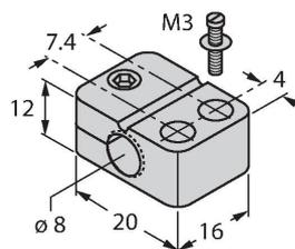
Монтажный зажим для цилиндрических резьбовых датчиков, с упором; материал: PA6
