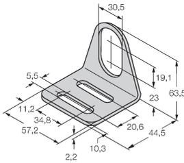
Монтажный кронштейн для цилиндрических резьбовых датчиков; материал: Нержавеющая сталь A2 1.4301 (AISI 304)
