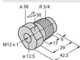
Монтажный переходник; материал: полипропилен; возможна замена датчика при заполненном контейнере (переходник остается в контейнере в процессе замены датчика)
