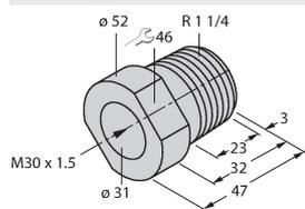
монтажный переходник, материал: полипропилен; возможна замена датчика при заполненном контейнере (переходник остается в контейнере во время замены датчика)
