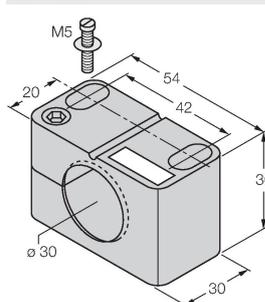
Монтажный зажим для цилиндрических резьбовых датчиков, с упором; материал: PA6
