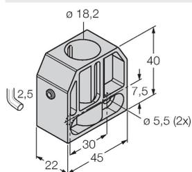
Монтажный зажим для цилиндрических резьбовых датчиков; материал: PA66-GF
