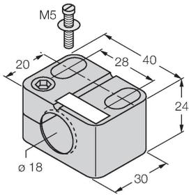
Монтажный зажим для цилиндрических резьбовых датчиков, с упором; материал: PA6
