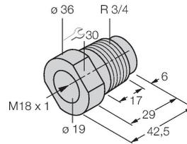
Монтажный переходник; материал: полипропилен; возможна замена датчика при заполненном контейнере (переходник остается в контейнере в процессе замены датчика)
