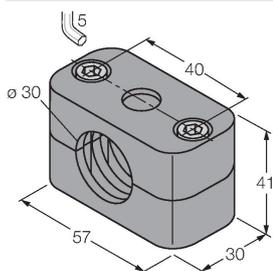
Монтажный зажим для цилиндрических гладких и резьбовых датчиков; материал: Полипропилен
