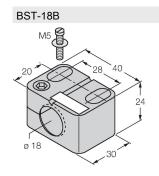
6947214 Монтажный зажим для цилиндрических резьбовых датчиков, с упором; материал: РА6
