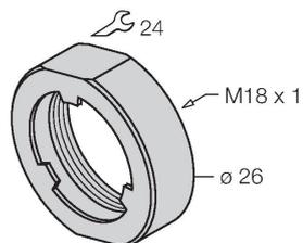
Гайка для защиты от ударов для резьбовых приборов M18x1; материал: Нерж. сталь A2 1.4305 (AISI 303)
