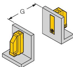
Установка друг с другом возможна при применении датчиков со смещенной частотой генератора BI5U-Q12.../F2.
