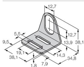
Монтажный кронштейн для цилиндрических резьбовых датчиков; материал: Нержавеющая сталь A2 1.4301 (AISI 304)
