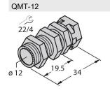
Кронштейн для быстрого монтажа со стопором; материал: латунь с покрытием PTFE; наружная резьба M16 × 1. Примечание. При использовании кронштейнов для быстрого монтажа дистанция переключения датчиков приближения может меняться.
