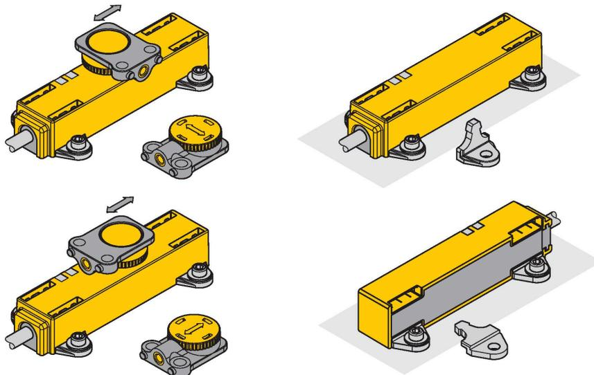
Множество монтажных аксессуаров обеспечивает гибкость установки. Позиционирующий элемент можно установить под углом 90°. Это обеспечивает гибкость при монтаже. Датчик линейного перемещения также может быть смонтирован под углом 90° с помощью 2-х винтовых соединителей. Благодаря принципу измерения, который основан на коммутации колебательного контура, датчик имеет иммунитет к намагниченным металлическим частям и другим помехам.
