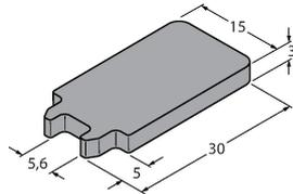
Съемник для монтажных элементов для датчиков линейного перемещения LI-Q17L
