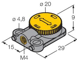
Плавающий позиционирующий элемент для датчиков линейного перемещения LI-QR14 и LI-Q17L; возможность поперечного и продольного монтажа; номинальная дистанция до датчика 1,5 мм; спаривание с датчиком на дистанции до 3 мм или допустимый зазор до 3 мм
