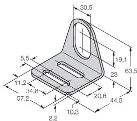
Монтажный кронштейн для цилиндрических резьбовых датчиков; материал: Нержавеющая сталь A2 1.4301 (AISI 304)
