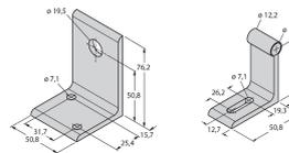
Монтажный кронштейн для головки датчика и стержня, для наружного монтажа
