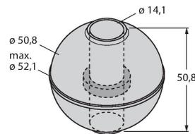
Позиционирующий элемент поплавкового типа, удельный вес 0,62 кг/м<sup>3</sup>, подходит для наружного монтажа для мониторинга уровня, материал: Нержавеющая сталь
