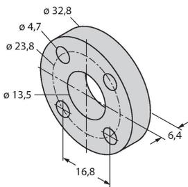
Стандартная проставка из неферритового материала для отделения позиционирующего элемента от основания штока гидравлического поршня
