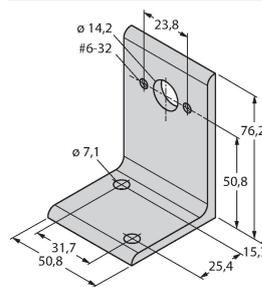
Монтажный кронштейн для позиционирующего элемента, для наружного монтажа
