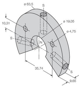
Кольцевой позиционирующий элемент с прорезью, можно использовать для наружного монтажа с монтажным кронштейном RB-R10, материал: Алюминий
