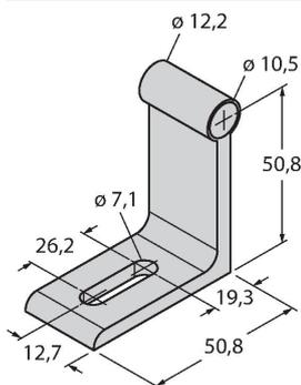
Монтажный кронштейн для головки датчика и стержня, для наружного монтажа
