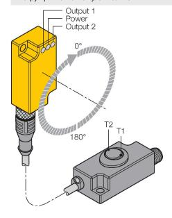
Точки переключения устанавливаются с помощью адаптера обучения ТХ1-Q20L60. При задействовании тумблера Т1 (OUT 1) между "массой" (GND) и контактом 5 образуется перемычка.
