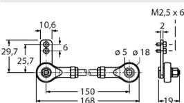
Металлический кронштейн, для энкодеров с полым валом, длина 150 мм; для применений с небольшим осевым и радиальным перемещением; гибко настраиваемый
