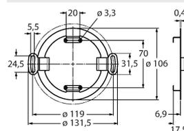
Крепление к статору из нерж.стали для энкодеров с полым валом, основной диаметр 119 мм, для высокочастотных применений с осевым и радиальным перемещением
