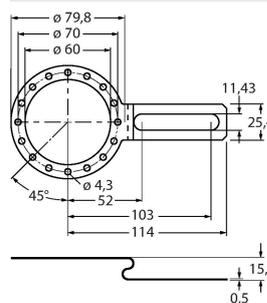
Монтажная панель из нерж.стали для энкодеров с полым валом, основной диаметр 104...206 мм, для применений с точками крепления на настраиваемом основном диаметре
