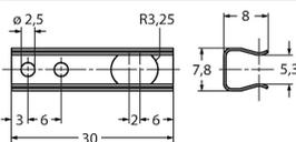
Установочный элемент из нержавеющей стали для энкодеров с полым валом, средний диаметр 110 мм, для применений с высоким осевым биением
