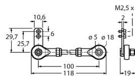
Металлический кронштейн, для энкодеров с полым валом, длина 100 мм; для применений с небольшим осевым и радиальным перемещением; гибко настраиваемый
