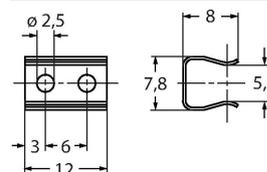
Установочный элемент из нержавеющей стали для энкодеров с полым валом, средний диаметр 76 мм, для применения в ограниченном пространстве
