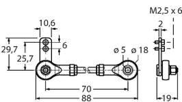
Металлический кронштейн, для энкодеров с полым валом, длина 70 мм; для применений с небольшим осевым и радиальным перемещением; гибко настраиваемый
