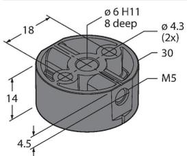
Позиционирующий элемент для энкодера RI-QR20, для валов Ø 6 мм
