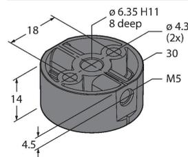
Позиционирующий элемент для энкодера RI-QR20, для валов Ø 6,35 мм
