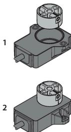
Существует два варианта монтажа. Один из вариантов — расположить позиционирующий элемент над корпусом датчика. Однако его также можно установить так, чтобы он полностью был в корпусе датчика.
